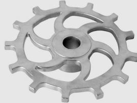
Engrenagem Guia/Motriz p/Esteiras 220 x 32mm Z13 (P. 2") Material: CF-8 (Aço Inox 304)
