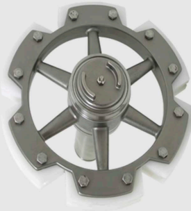
Roda Guia/Motriz p/ Nórea ø300mm Modelo P. 6" Material: CF-8 (Aço Inox 304)
