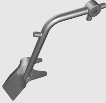
Colher Aparadora de Peito Material: CF-8 (Aço Inox 304)
